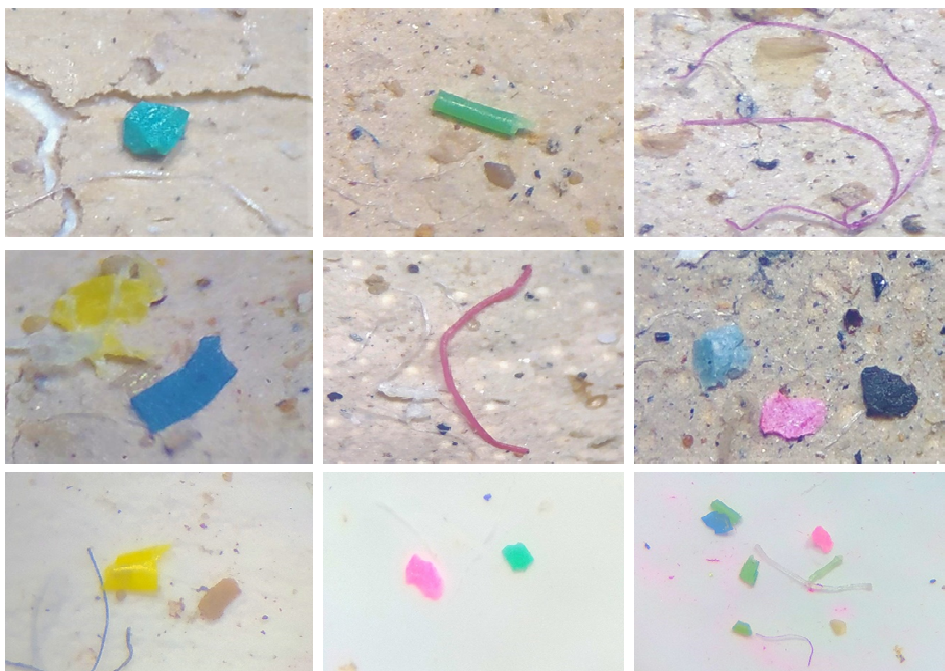
Hình 6. Kết quả xác định vi nhựa trong trầm tích dưới kính hiển vi huỳnh quang.
